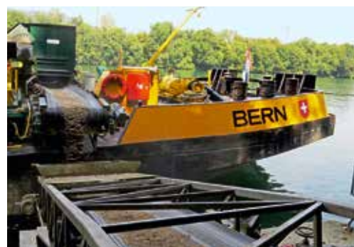
Nachhaltige Selbstentladevorrichtung über Förderbänder der MS Bern
