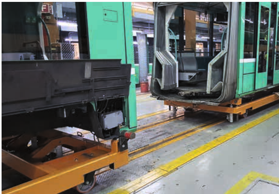
Spezielle Rollwagen vereinfachen das Trennen und Verschieben der Combino-Module.
