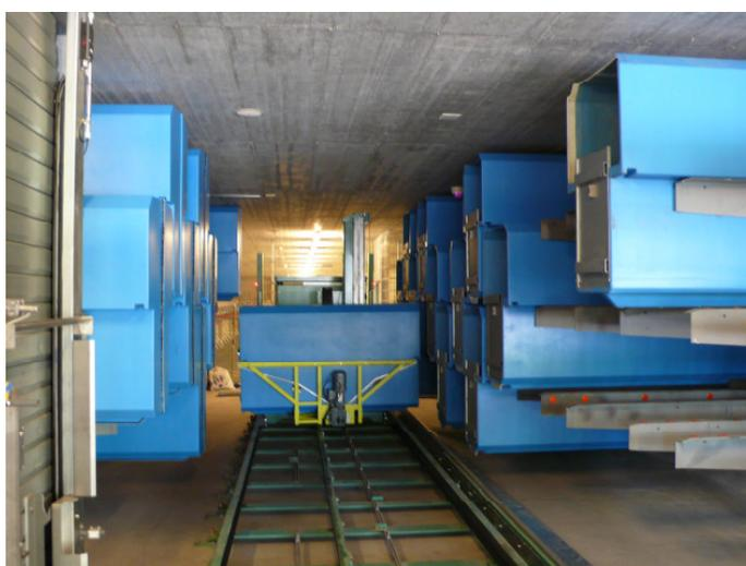
Blick in das Lager mit zwei Reihen Boxen. In der Mitte wird gerade eine Box automatisch zur Übergabestelle transportiert.
