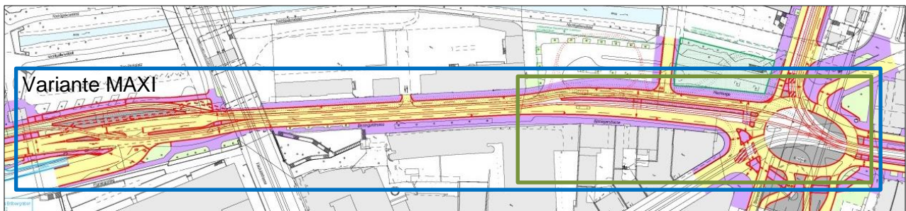
Abb. 9: Entwurf Anpassung Verkehr Binnergerstrasse, Variante MAXI. Stand: Vorstudie (Kein Massstab, Plan nicht genordet)
