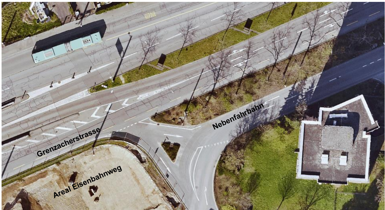
Abbildung 10: Heutige Situation: Grenzacherstrasse ohne Fussgängerverbindung, gross dimensionierte Einmündung beim Areal Eisenbahnweg
