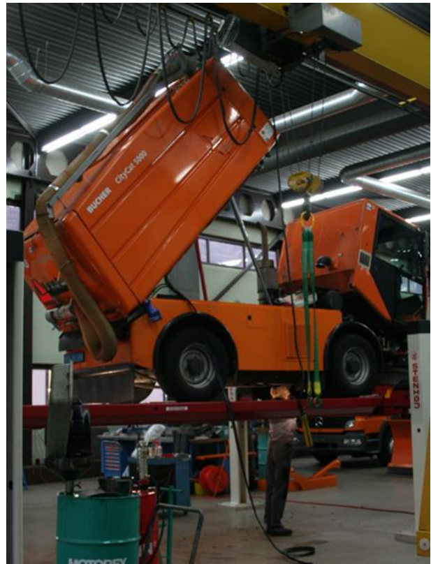
Abb. 13: Ungenügende Arbeitshöhe «Werkstatt leicht» Konflikt mit der Kranbahn
