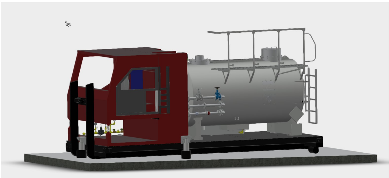
Abbildung: Simulation der mobilen Gefahrstoffanlage.
