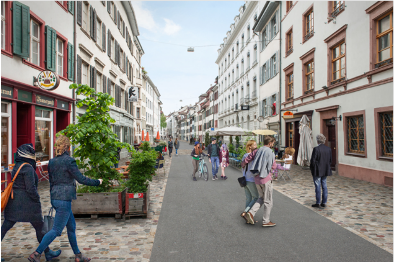
Visualisierung: Blick in die Rheingasse mit Kieselwackepflasterung und mittigem Asphaltband
