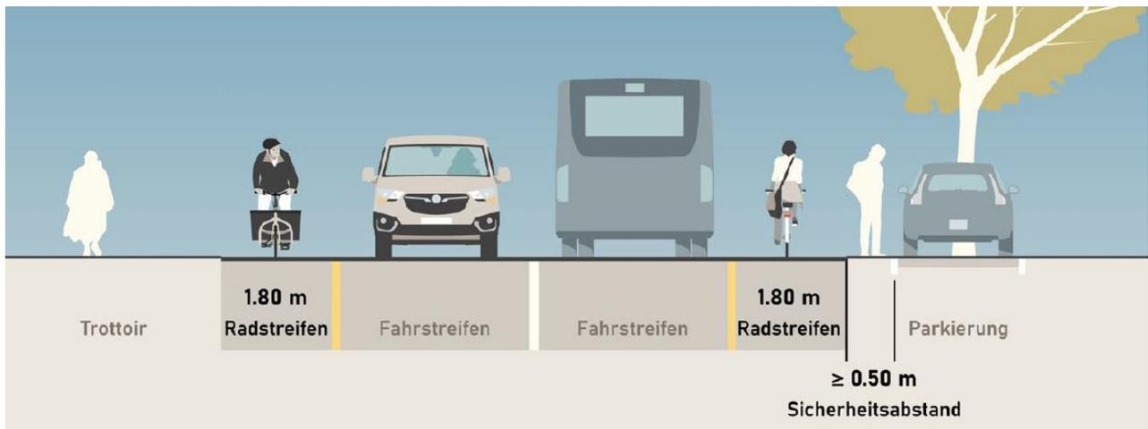
Abbildung 2: Sicherheitsabstand bei Parkierung MIV neben der Fahrbahn mit baulichem Niveauunterschied oder mittels Markierung
