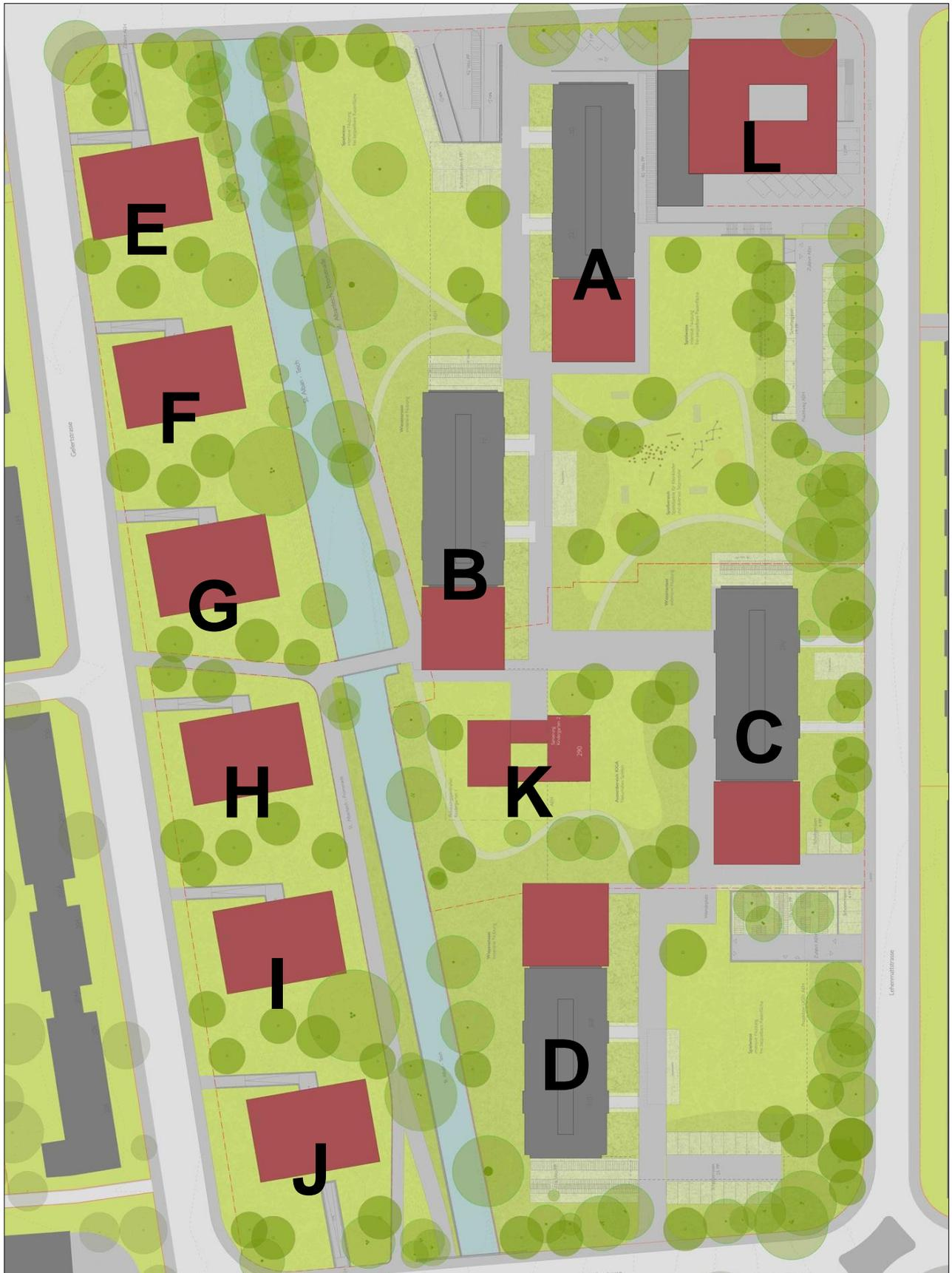
Abb. 4: Areal Albenteich-Promenade: Rot = Erweiterung, Ersatz, Aufstockung. Stand Vorprojekt. Quelle: Westpol Architekten (kein Massstab, Plan genordet)
