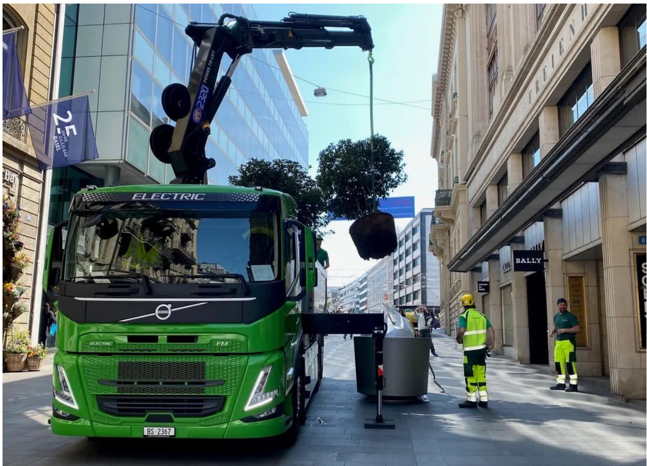
Abb.1: Vollelektrischer LKW mit Kran und Kippbrücke beim Abladen des mobilen Grüns in der Freien Strasse 2025
